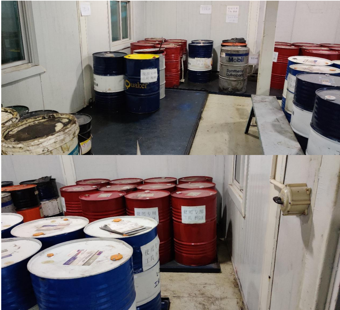
流体库房内为水泥硬化地面，油桶存放于钢制池内。
