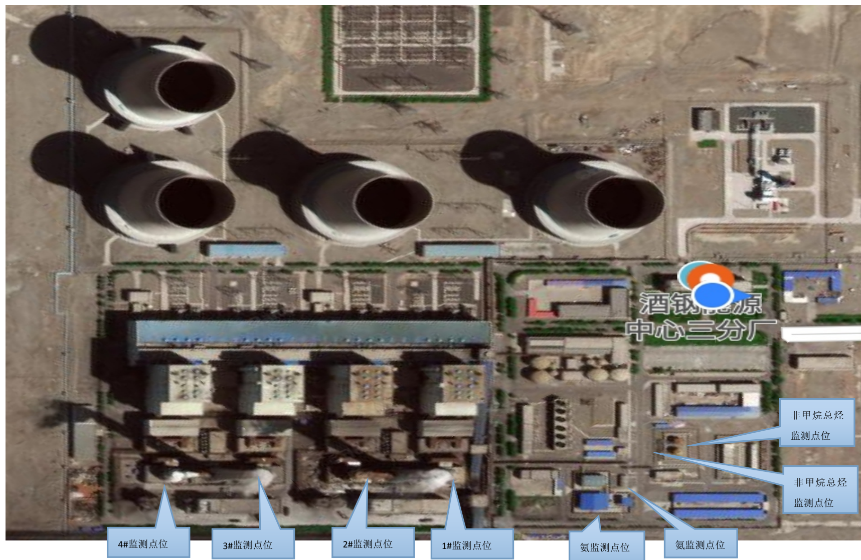
电厂 4×350MW 机组排污监测点示意图 5-6
